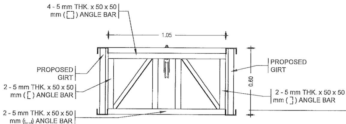
**3 STEEL PULLEY SECTION DET.**
